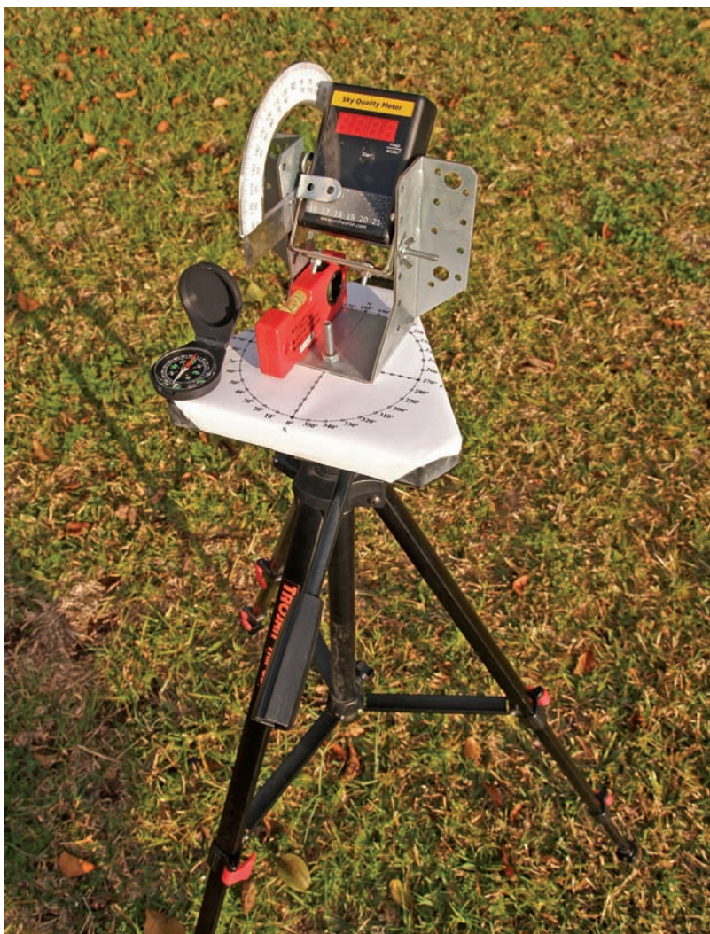
Figura 5. Dispositivo SQM montado sobre un soporte de construcción casera pero preciso, que permite efectuar medidas en diferentes valores de acimut y altura. Para que las medidas angulares sean correctas se emplean, como se aprecia en la figura, un nivel de burbuja y una brújula. (Foto B. Troughton)
