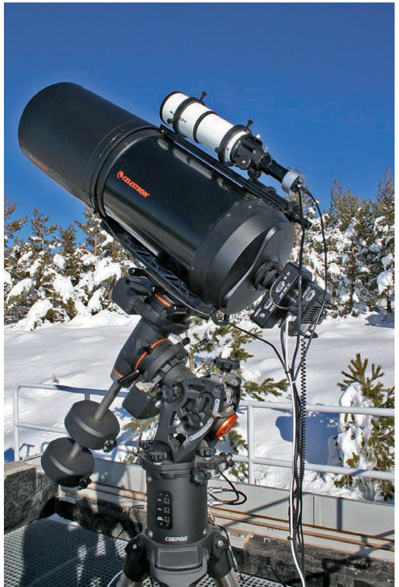
Figura 1. El instrumental básico para la medida del brillo de fondo de cielo por métodos fotométricos absolutos: un telescopio (a poder ser automatizado), equipado con cámara CCD astronómica y rueda de filtros. (Foto J. Aceituno, Itec Astronómica)
